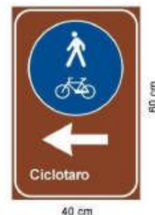
Fig 4: Cartello avviare a itinerario ciclopedonale su viabilità riservata ottenuto da modifiche delle figure 360 - 363 art 136 DPR 495/92
