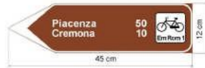
Fig 1: Segnale di direzione per contesti extraurbani per viabilità riservata (riduzione da segnale tabella II 14a DPR 495/92)
