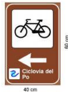
Fig 3: Cartello per avviare a itinerario ciclopedonale generico ottenuto da modifiche delle figure 360 - 363 art 136 DPR 495/92
